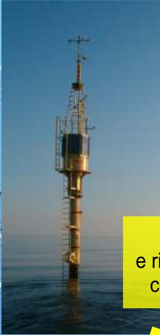
La BOA ODAS ITALIA 1 è dotata di fanale giallo e riflettore radar ed è boa è dotata di ormeggio elastico che le consente di muoversi entro un raggio di 2 Km
